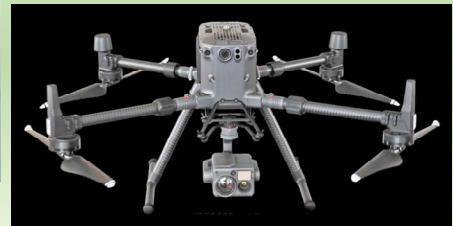
DJI Matrice 300 mit Kamera H20T Abfluggewicht ca. 7 kg
