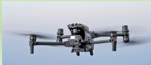
DJI Matrice 30 Thermal (M30T) Abfluggewicht ca. 3,7 kg
