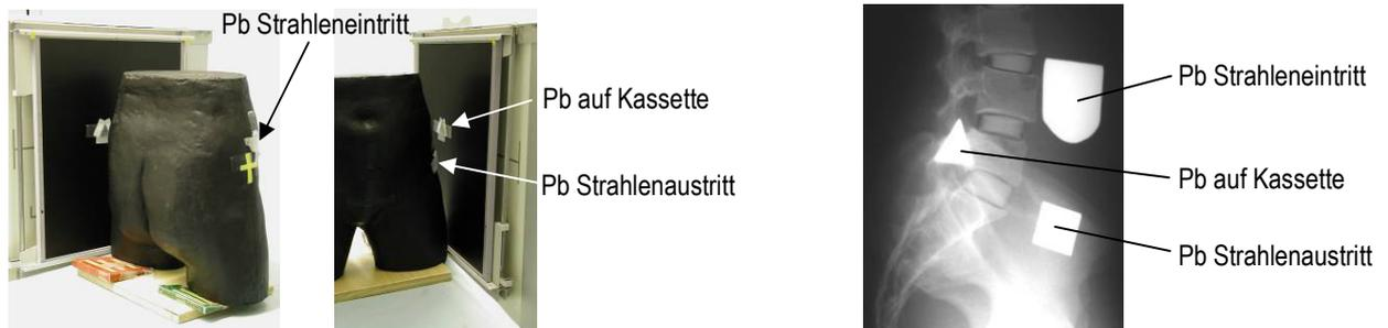
Abb. 6-9 bis 6-11: Lage der Bleimarkierungen am Rumpf-Phantom und auf dem Röntgenbild
