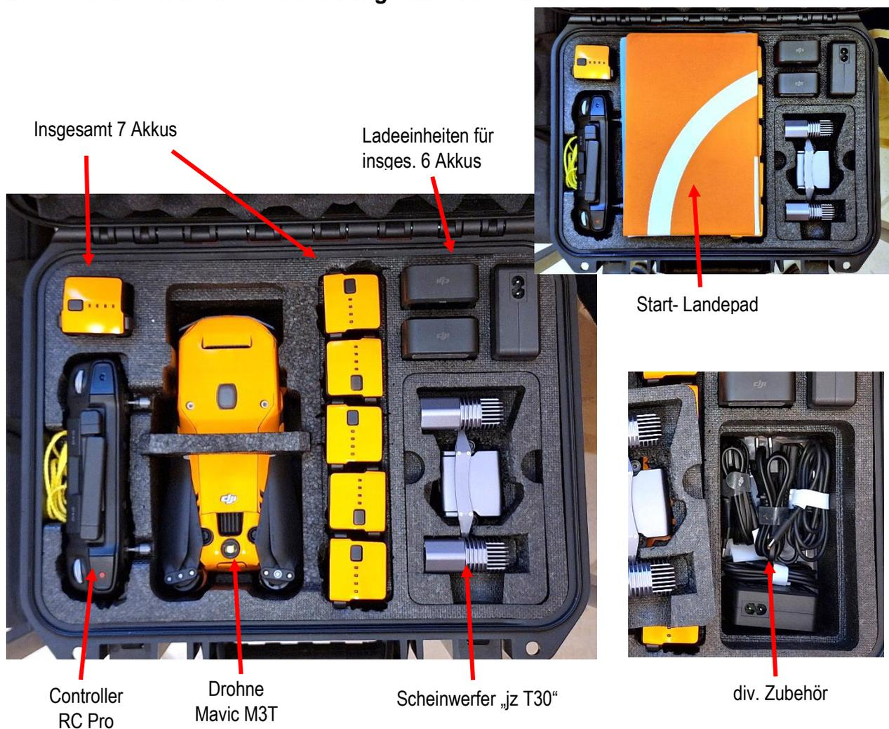
Um eine bessere Erkennbarkeit der Drohne zu erreichen, habe ich alle meine Drohnen mit einer Leuchtfarben-Folierung versehen. Für die DJI M3T gibt es fertig konfektionierte Folienteile.
