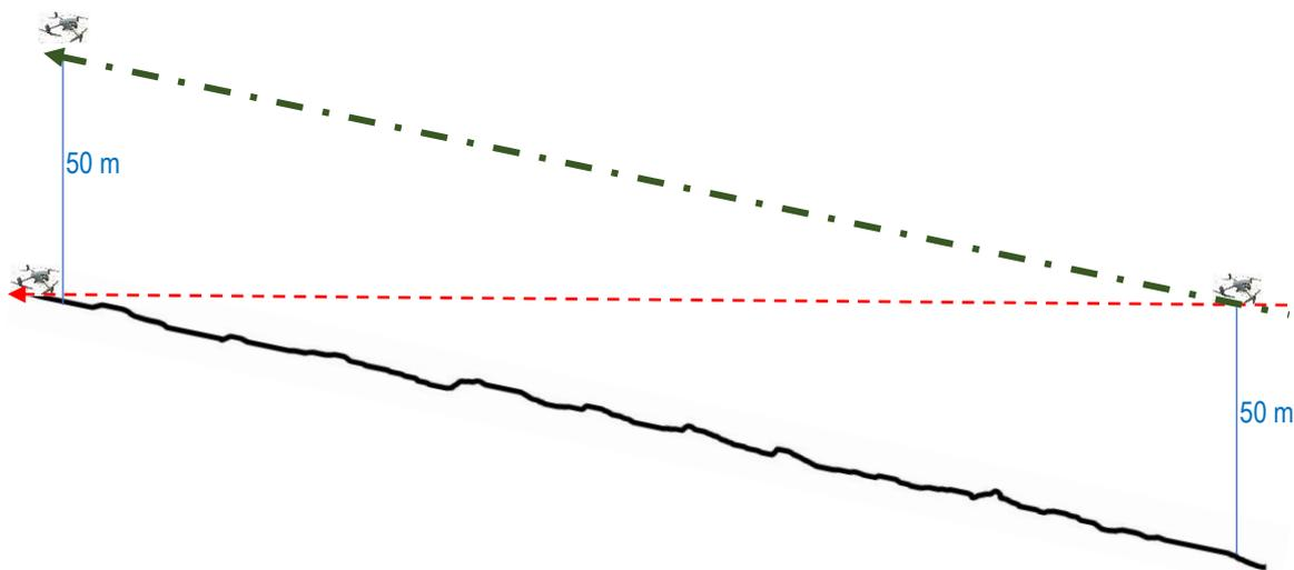
Es gibt Möglichkeiten, eine **automatische Höhenanpassung** für den Flug zu programmieren. Dies mit Hilfe von Flugplanungsprogrammen am PC (z.B. QGroundControl oder UAV Editor) oder direkt am DJI Controller mit der Pilot2 App.
